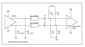
FIGURE 5E. HIPERCLOCKS CLK/nCLK INPUT DRIVEN BY 3.3V LVPECL DRIVER WITH AC COUPLE
