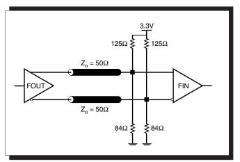
FIGURE 4B. LVPECL OUTPUT TERMINATION
