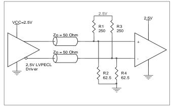
FIGURE 3A. 2.5V LVPECL DRIVER TERMINATION EXAMPLE
