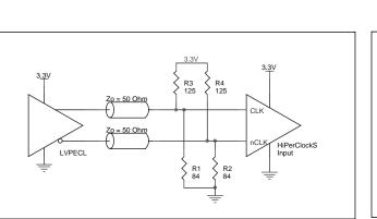
FIGURE 5C. HIPERCLOCKS CLK/NCLK INPUT DRIVEN BY 3.3V LVPECL DRIVER
