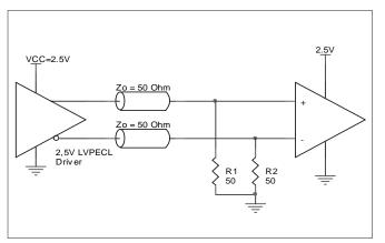
FIGURE 3C. 2.5V LVPECL TERMINATION EXAMPLE
