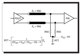
FIGURE 4A. LVPECL OUTPUT TERMINATION
